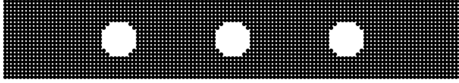
Рис.1. Пример дискретизации, балка с перфорацией.
